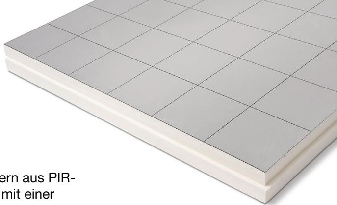
Eurothane Silver E FR ist eine Wärmedämmplatte mit einem Kern aus PIR-Hartschaum (Polyisocyanurat). Die Platte ist auf beiden Seiten mit einer diffusionsdichten Mehrschichtfolie belegt.
