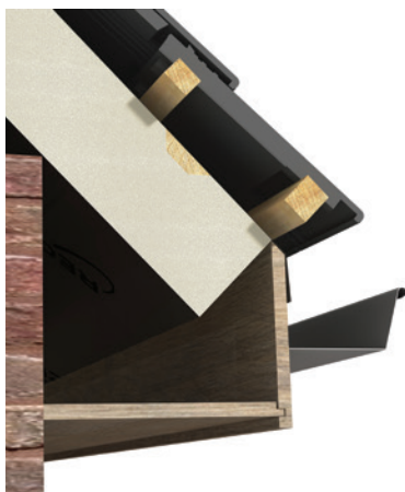
Figures 18 et 19 : les tasseaux en bois peuvent réduire les déchets de coupe
