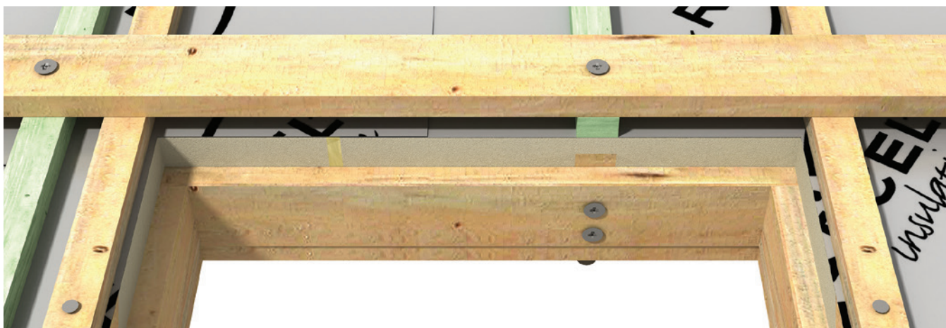
Figure 11 : le cadre en bois ne forme pas de pont thermique et est fixé aux raidisseurs intégrés.
