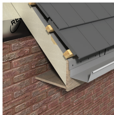
Figuur 20: afschuining ter hoogte van de goot
