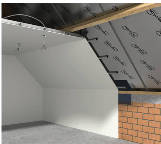
Figuur 21: mogelijke binnenafwerking met kabelspouw
