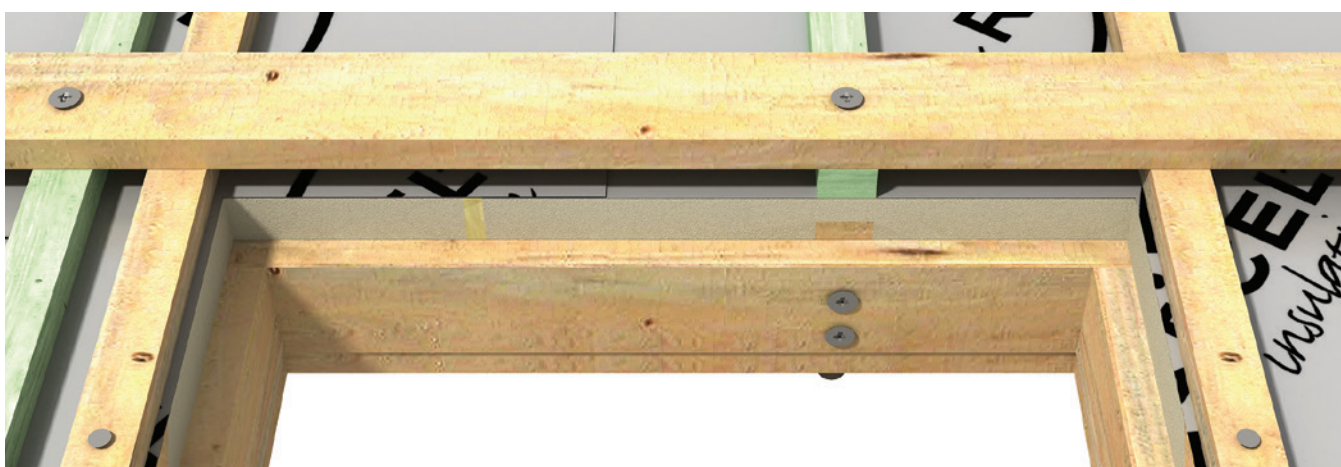
Figuur 11: houten kader vormt geen bouwknoop en wordt bevestigd aan de geïntegreerde balken
