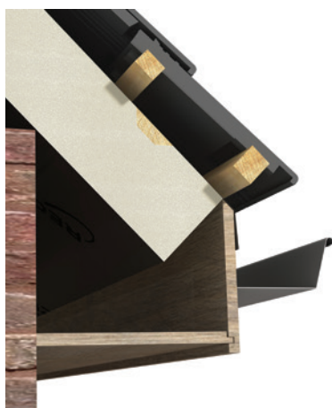
Figuren 18 en 19: houten klossen kunnen zaagafval minimaliseren
