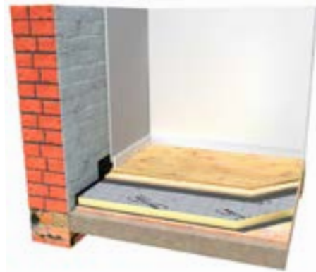
Figure 56 : Isoler sur un sol existant
