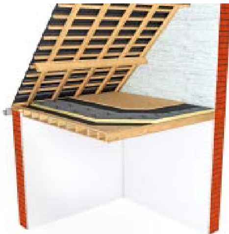
Figure 57 : Isoler sur un sol intermédiaire en bois
