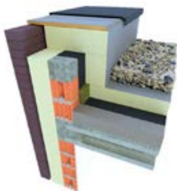
Figure 26 : Pont thermique à hauteur de la maçonnerie verticale
