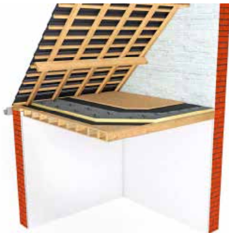
Figure 57 : Isoler sur un sol intermédiaire en bois
