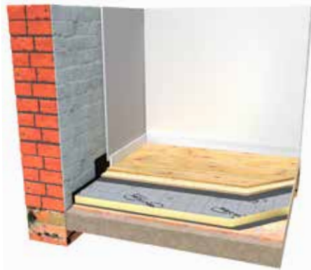
Figure 56 : Isoler sur un sol existant
