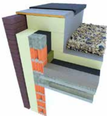
Figure 25 : Pont thermique à hauteur de la maçonnerie verticale
