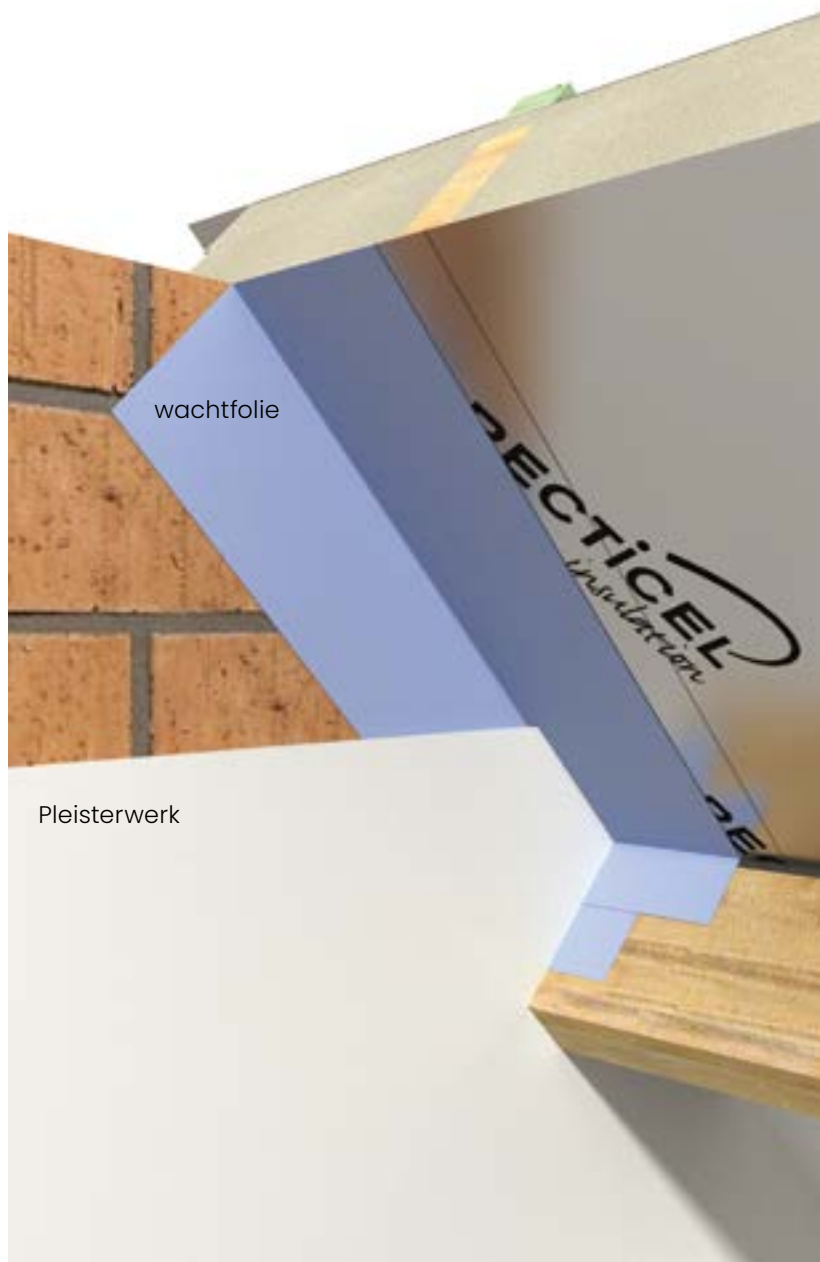
Figuur 37: Aansluiting dakvlak en pleisterwerk
