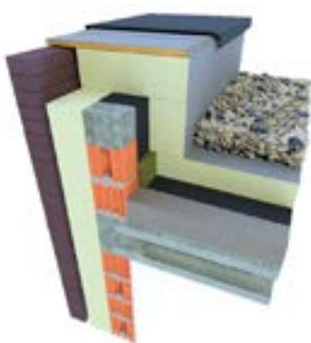
Figuur 25: Opstanddetail gemetste dakopstand
