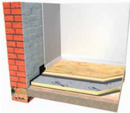
Figuur 56: Isoleren op bestaande vloer
