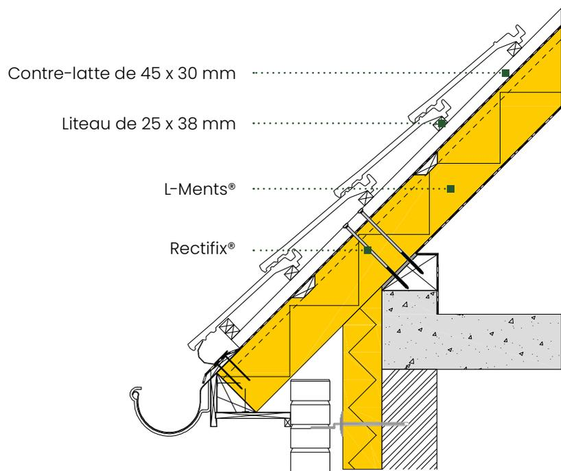
Raccordement de gouttière sans traversée
