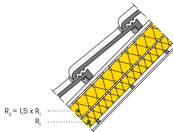
**CONSEIL I :** pour éviter la condensation, installez toujours le pare-air et le pare-vapeur du côté chaud de l'isolation. Il s'agit toujours du côté intérieur du bâtiment.
