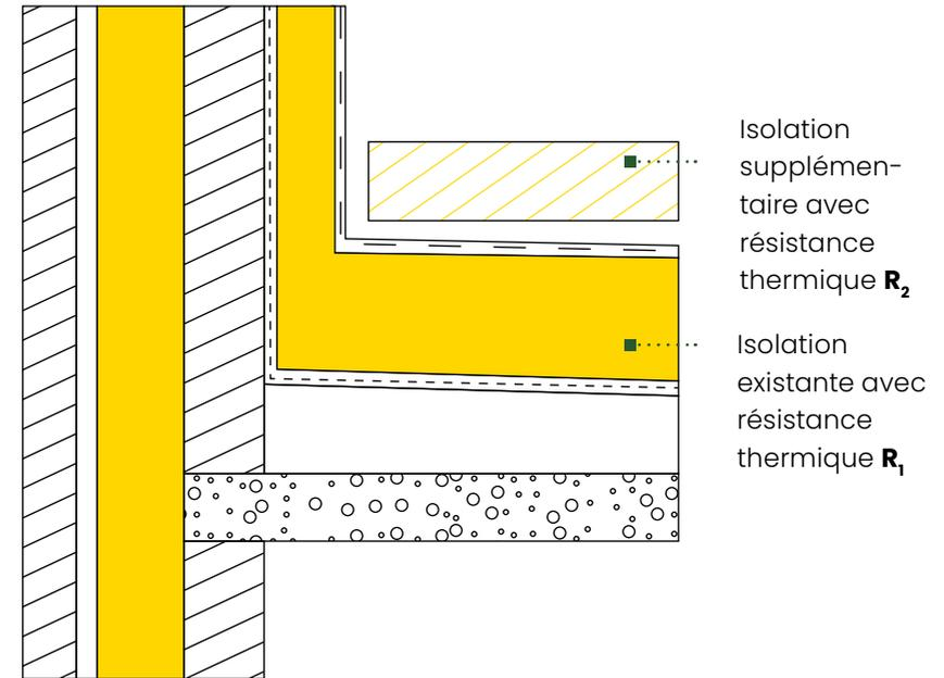
De cette façon, le point de rosée se trouve toujours à l'extérieur de la couverture originale de la toiture. Si cette condition n'est pas remplie, la condensation peut se former entre l'isolation d'origine et la membrane de toiture située par dessus.
