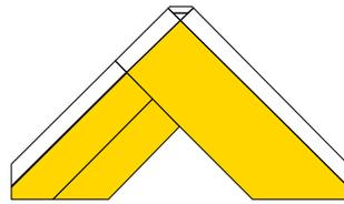
Une contre-latte supplémentaire doit être vissée sur le bout du panneau supérieur et un écran de sous-toiture doit recouvrir le faîte afin d'éviter tout risque d'infiltration et d'accumulation d'eau dans les joints.
