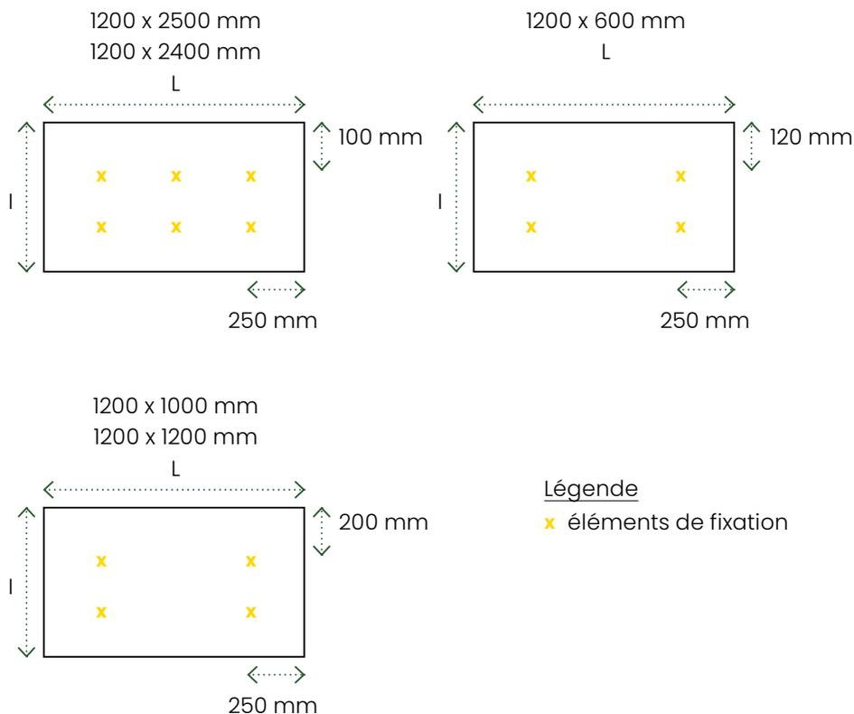
**CONSEIL :** dans le cas de systèmes d'isolation à 2 couches, la première couche peut être fixée avec 1 vis par panneau. La deuxième couche est ensuite fixée par l'ensemble de l'isolation jusqu'à la dalle portante. Les panneaux d'isolation doivent toujours être disposés en quinconce (dans une couche et entre les couches).
