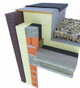
**Solution 2 :** rive de toiture en maçonnerie traditionnelle avec isolation PU. Prévoir une isolation souple entre l'isolation PU de la toiture et la rive de toiture. Cette isolation souple peut être constituée d'environ 3 centimètres de laine minérale de faible densité ( $35 \text{ kg/m}^3$ ) ou de mousse PU permanente souple. L'isolation verticale de la rive de toiture est placée jusqu'à la partie supérieure de l'isolation du toit.
