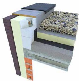
**Solution 1 :** rive de toiture en blocs isolés (préfabriqués, préperforés), fixée mécaniquement dans la dalle-toiture portante.
