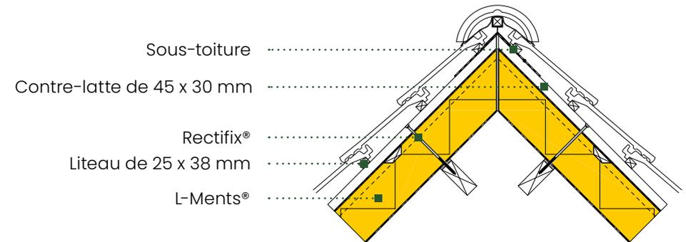
**Remarque :** un écran de sous-toiture doit recouvrir le faîte afin d'éviter tout risque d'infiltration et d'accumulation d'eau dans les joints.
