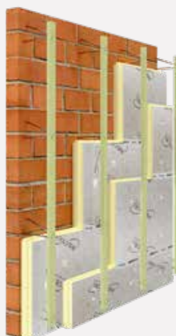
Stap 2 Zelfdragende gevelconstructie monteren met de gevelmontageschroeven.
