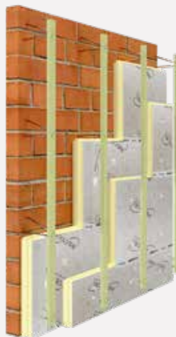
Stap 2 Zelfdragende gevelconstructie monteren met de gevelmontageschroeven.
