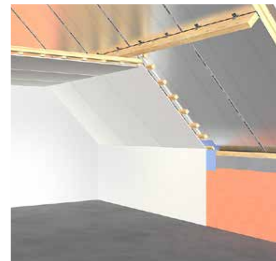
Figuur 21: mogelijke binnenafwerking met kabelspouw
