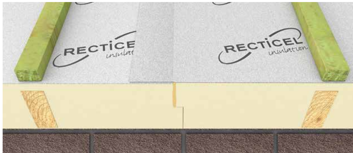
Figuur 14: de langsvog wordt opgeschuimd met laag-expansief flexibel PU-schuim en overkleefd met de geïntegreerde onderdakfolie
