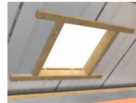
Figuur 13: bijkomende versterking langs de binnenzijde
