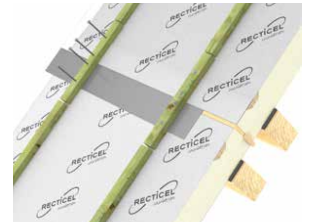
Figuur 23: afwerking van een dwarse naad. De ruimte tussen de twee tengellatten vult u op met een stuk tengellat dat u opnieuw schroeft door het paneel tot op de gording.
