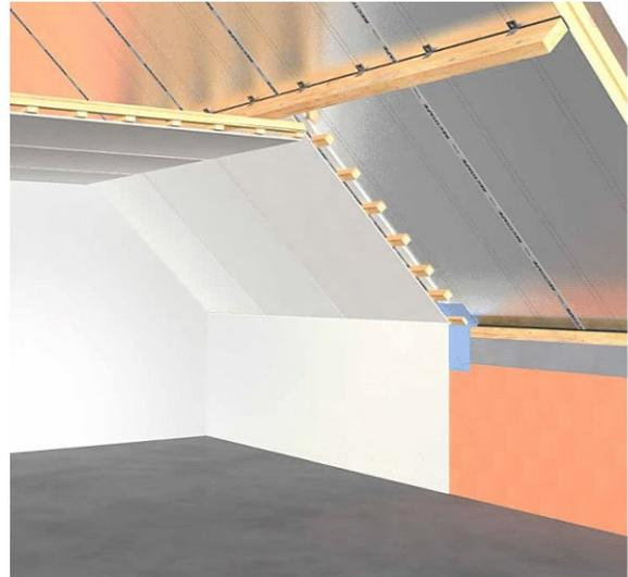
Figure 22 : plafond intérieur avec vide permettant le passage de gaines électriques et l'ajout d'une couche acoustique
