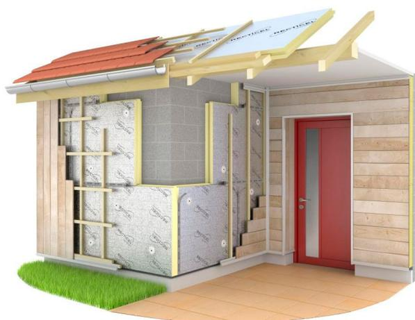
Bardage ventilé avec ossature en bois fixée au travers de l'isolant
