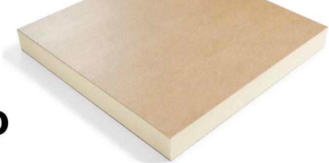
Eurothane® Br-Bio, le panneau haute performance d'isolation thermique support d'étanchéité pour toitures terrasses. Il possède une âme en mousse polyisocyanurate rigide revêtue sur chaque face d'un parement étanche composite polyester, kraft et aluminium.
