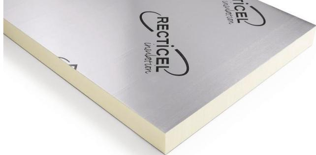
Le panneau Eurotan<sup>®</sup> est un panneau d'isolation thermique avec une âme en mousse polyisocyanurate rigide revêtue, sur deux faces, d'un parement étanche composite kraft et aluminium.
