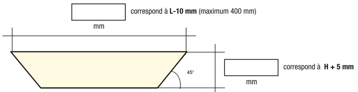
**Remarque :** la hauteur sera arrondie à une épaisseur standard supérieure. Exemple  $H = 30 + 5$  mm, la hauteur de la bande sera de 40 mm
