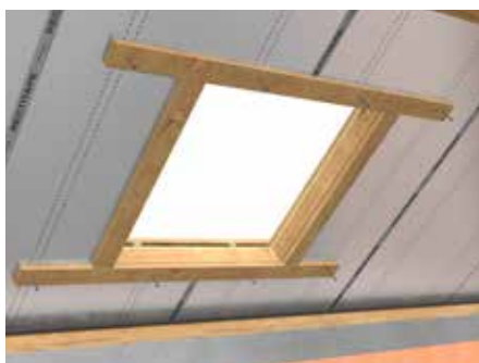
Rysunek 13: dodatkowe wzmocnienie od wewnątrz
