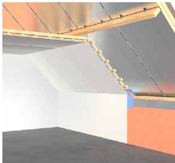
Rysunek 22: przykład wykończenia od wewnątrz z uwzględnieniem przestrzeni na okablowanie
