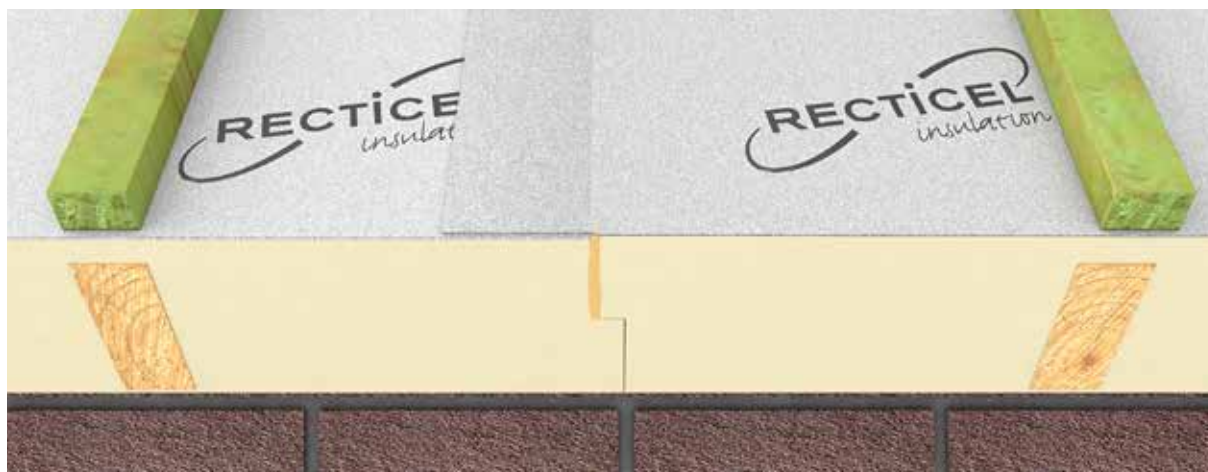
Rysunek 14: podłużna fuga wypełniona zostaje niskorozprężną, elastyczną pianą PU i kolejno przykryta zakładem zintegrowanej folii dachowej
