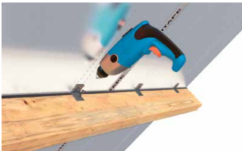
Rysunek 8: mocowanie od wewnątrz z profilem kątowym
