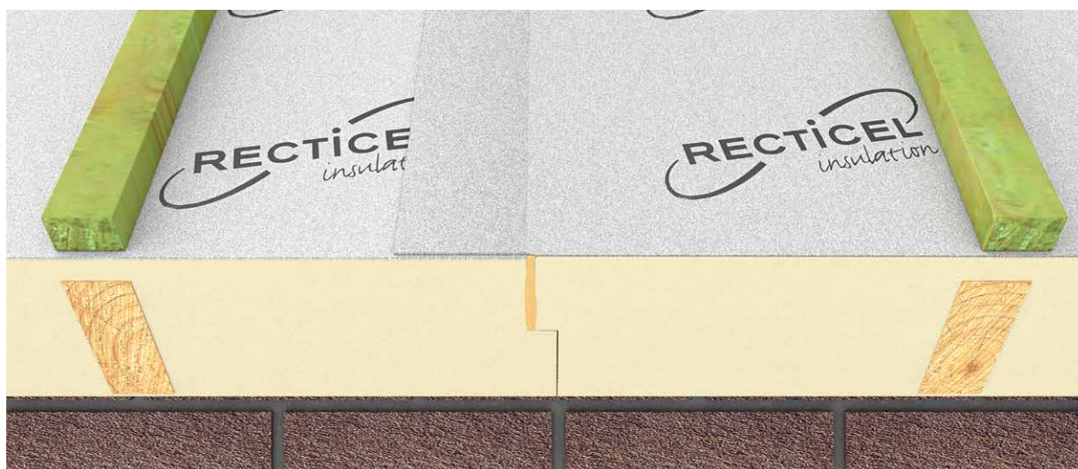
Figure 14 : le joint longitudinal est comblé avec une mousse PU flexible à faible expansion et recouvert par l'écran de sous-toiture adhésif
