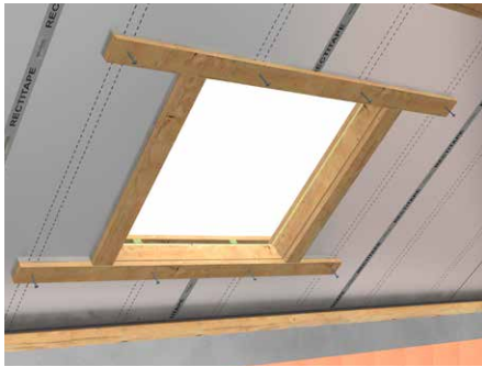
Figure 13 : renfort supplémentaire par l'intérieur
