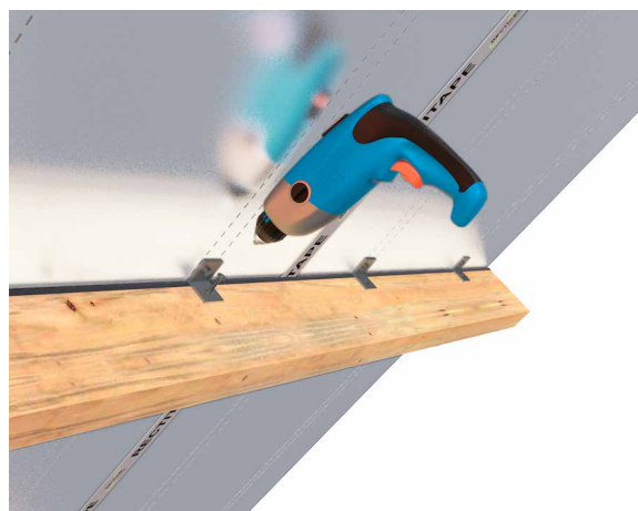
Figure 8 : fixation de l'intérieur avec un profil en L
